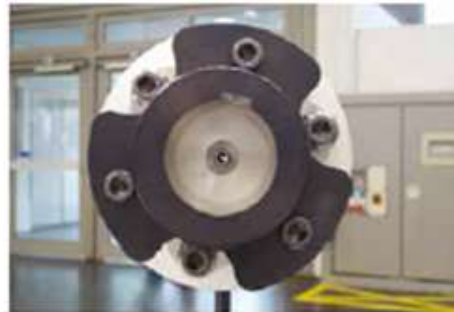
このMLPシリーズカップリングの最たる特徴は、内側の穴です。長いスピンドルを伴う場合には、クーラントが内側の管を通して直接ワークに届きます。
