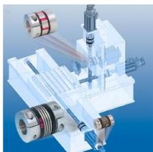
工作機械の数だけ部品があります。共通部品である駆動源、リニアガイド、ツールホルダ、ワーク固定治具に加えて、ゼロバックラッシのカップリングなどの「繋ぐ」部品も含まれます。ここで特に
