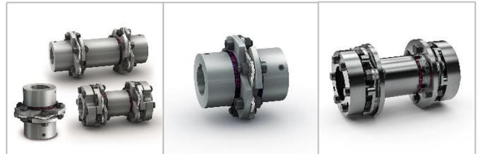
板ばね形カップリングは、多くの用途、特に製鉄所など重工業向けとしての価値が実証されています。ドイツのクリンゲンベルクにある R+W の営業部北東チーム、Mirko Fries は板ばね形カップリング MLP シリーズを、効率的で洗練された製品としてお勧めしています。「MLP シリーズは、ハブと板ばねが摩擦力によって接続されているため、逆転が伴う場合でも最大限のトルクが伝達できると同時に耐摩耗性が高く、メンテナンス不要です。つまり、コストと労力が削減され、設備の稼働率と信頼性が向上します。」
