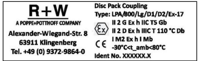
ディスクパック・カップリング MLPA(I)は、危険区域グループ II カテゴリー 2 の G(ガス、蒸気と空気との混合物)とカテゴリー 3 の D(粉塵)で温度等級 T5 の最大表面温度は 110℃です。グループ I の鉱業でも、カップリングは M2 と M3、T5 に対応しています。カップリングは内側でも外側でも使用できます。
