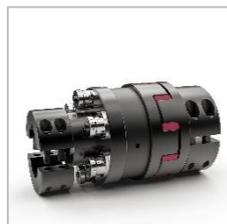
ます。これにより、修理費用と設備停止時間を大幅に削減できます。トルク過負荷の原因を取り除いたあと、安全クラッチ外周部に組み付けられているプランジャに軸方向の力を加えれば、安全クラッチは素早く簡単に再連結できます。安全クラッチは、振動を減衰させ衝撃を吸収すると同時に、偏心、偏角、エンドブレイ方向のミスアライメントを許容できるように、エラストマ形カップリングと一体化した状態で設計されています。両側半割クランプ締結、または片側はフランジにもう一方はキー締結ハブを組み合わせるような、ご希望に沿った締結方法に対応いたします。安全クラッチは、軸直角方向から取り付け、取り外しが可能で、モータを取り外すことなく取り付けられます。押し出し機向け特殊安全クラッチは、200~14,000N・mの遮断トルクに対応しており、オプションで ATEX 認定も承っております。
