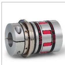
法、必要なスペースは、たくさんの要素のうちのほんの一部です。MSK シリーズの精密安全クラッチは低いトルク(0.1~2,800N・m)の用途に適しています。締結方法は、キー、テーパロック、クランプ、半割クランプなど、さまざまです。機械の設計によっては、スプロケットまたはプーリを用い 1 軸で使用することもできます。また、原点復帰型、インデックス型、フリーホイール型、負荷保持型など、4 つの遮断システムをご用意しております。それとは別に、カスタマイズも可能です。
