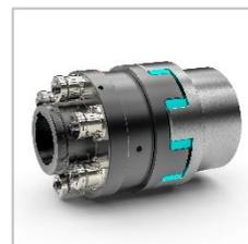
らしたりすることができるほか、指定の範囲内なら設定遮断トルクを変更することも可能です。ハブとエラストマ形カップリングは鋳鉄製です(ダクタイル鋳鉄 40)。エラストマインサートは TPU またはハイトレル®製で、押し出し機の使用方法に合わせたショア硬さを選択できます。例えば 98Sh A(高振動減衰)または 64Sh D(高剛性)のショア硬さのエラストマインサートを取り扱っており、各タイプは色によって区別されています。エラストマは、カップリングおよびドライブライン全体の特性を左右し、回転方向の振動を最適化するのに役立ちます。
