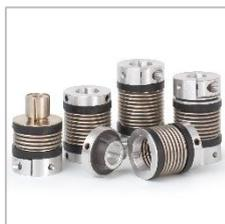
ョメータや計測・制御システムに関連する正確な回転動力伝達のために使用することができます。剛性の高い金属ベローズにより、MK シリーズは、ミスアライメントを許容しながら、同時に、極めて正確に測定を行うのに役立ちます。Jörg Stang は「MK シリーズは、すり割りの入ったクランプタイプをはじめ、半割クランプ、テーパロック、中空軸への締結が可能なコレット軸タイプのもまで、多くの締結方法があり、どんな用途にも対応しています。取り付けが簡単な分離アダプタタイプもご用意しており、ゼロバックラッシで、素早く・簡単に取り付け可能な設計が特長です。」と説明します。ガラス繊維入り FRP 製の特殊なテーパ部は、カップリングの電気絶縁性と断熱性を実現しながら、ゼロバックラッシでメンテナンス不要であることを保証します。テーパ部には異なる 2 種類の材料を使用しているため、カジリが発生しにくいようになっています。これらの分離アダプタタイプのカップリングは、アダプタ接合部をシングルポジションまたはマルチポジションからお選びいただけます。
