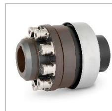
カップリングが多く使用されていましたが、現在は MST2 が制御可能な信頼性の高い緊急停止装置として動作します。また、メンテナンス費用が極めて低く、取り扱いが簡単であるというメリットがあります。設備故障により動力が遮断された後は、カップリングを元の位置に戻すだけです。カップリングに組み込まれたトルクモジュールをプラスチックハンマーで叩くと、カップリングはすぐにお使いいただけるようになります。従来のシャーピンカップリングや流体継手と比べて、ピン、オイル、特別なポンプなどの追加の消耗品は必要ありません。したがって、特別な資格のない担当者も素早く、簡単に再連結を行うことができるのです。
