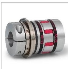
MELS2 は、標準的なジョーカップリングのハブが使用されています。ハブの間には、異なるショア硬さが選択可能で、駆動被動間のミスアライメントを許容する柔軟なエラストマインサートがあります。しかし片方のハブには、予圧を与えたばねを利用したボールソケット式の安全クラッチ機能を備えており、バックラッシュが発生しないようになっています。クラッチボールがカップリングの本体に支えられており、特殊な皿ばねが動力伝達の基盤となります。伝達されるトルクが設定トルク値に達すると、エンジンとギアの間の動力は、ミリ秒以内に完全に遮断されます。
