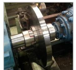
頻度で発生します。このトルクは時間の経過とともに、ユニバーサルシャフト、オイルワイパー、ロール表面などの部品に繰り返し損傷を与え、高価なギヤボックスの損傷に至ることもあります。この問題を解決するために R+W は、精密安全クラッチと一体化したエラストマ形カップリングを紹介しました。この安全クラッチはばねを利用したボールソケット式で、設定されたトルクに達すると、数ミリ秒以内に動力を遮断します。トルクが再び通常に戻ると、カップリングは自動的に再連結し、トルクを伝達し続けます。動力の遮断は、移動リングの移動を近接スイッチで検出することができ、すぐに機械を停止させることができます。ブレーキを保持するのに必要なブレーキディスクもカップリングに含まれています。また R+W の技術者は、既存のカップリングを置き換えることで他の部品の修正などが発生しないように、カップリングの形状を適応させました。お客様にとっては無理のない置き換えで済み、将来的には設備の可動率が向上するでしょう。
