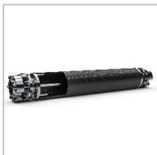
さまざまな標準品に加えて、中間軸にクーラント供給システムが一体化した特殊品もご用意しております。これは、特に DBSE が長い工作機械を扱うメーカーにとっては、大きなメリットです。特別に設計されたこのカップリングは、パイプの両端にハブが固定されており、長い距離でもクーラントを直接工具に導くことができます。テーパロックハブと動バランス取りによって、滑らかな動作と最小限の振動が実現します。さらに、軸のミスアライメントは、剛性の高い板ばねによって許容されます。耐久性が高く、強力な MLP シリーズは、お客様にシンプルな設計、短い組み立て時間、速い加工速度、永い寿命をもたらします。
