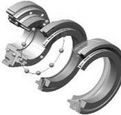
オーバートルクが検出されると皿バネは完全に反転し、移動リングにはバネ圧が残らない設計になっています。駆動側と被駆動側は完全に切り離されます
