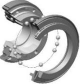
オーバートルクが発生した場合、標準の①原点復帰型 (W) と②インデックス型 (D) では、バネが外れてボールがソケットから飛び出し、駆動側と被駆動側を切り離します。ごくわずかなバネ圧が残るため、トルクが設定した切り離しトルク値よりも低くなると、安全クラッチは自動で再連結します (グラフ 1)。
